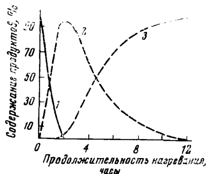
Рис. 2. Изменение содержания гомополимера (1), блок-сополимера (2) и смешанного полиамида (3) в зависимости от продолжительности нагревания смеси гомополиамидов
